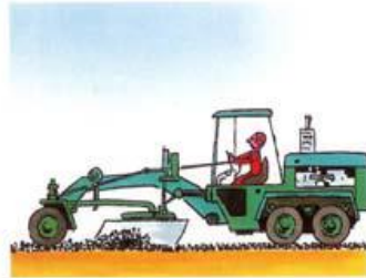
Humectación, perfilado y mezclado
