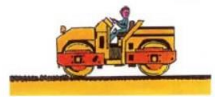
Mezclado suelo /agua/ emulsión y compactación de la mezcla
