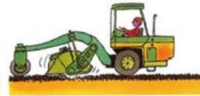
Mezclado suelo /agua/ emulsión y compactación de la mezcla
